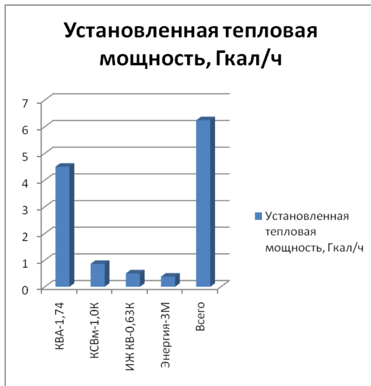
Рисунок 2.2. Установленная мощность котлоагрегатов, установленных в котельных на территории сельского поселения «Куниб»
